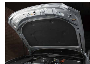
自動車 フードサイレンサーおよびエンジン周り [吸音材・断熱材 (耐熱性)] Automobiles hood silencer and parts around the engine [sound-absorbing material, heat insulation material (heat resistant)]
