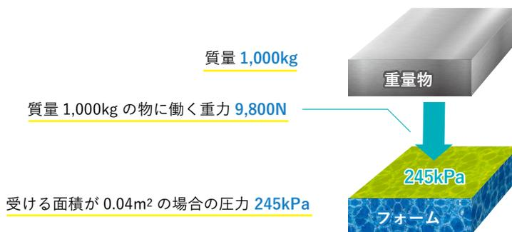
上記のとおり、1,000kgの重量物を、厚み10mm×幅200mm×長さ200mmのフォームに載せると、245kPaの圧力が上からかかることがわかります。
