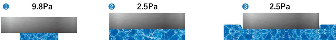
力を受ける面積が増えることで力が分散され、圧力が低下し、フォームがより圧縮されにくくなります。
