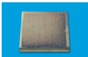
銀板をイオウ加硫品(他社品 EPDM フォーム)と同じ容器内で加熱すると、黒く変色します。
