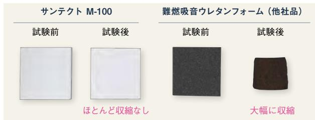
※ JIS K 6767 準用 熱的安定性(加熱寸法変化率)。
