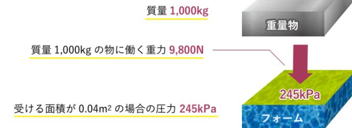
上記のとおり、1,000kg の重量物を、厚み 10mm × 幅 200mm × 長さ 200mm のフォームに載せると、245kPa の圧力が上からかかることがわかります。
